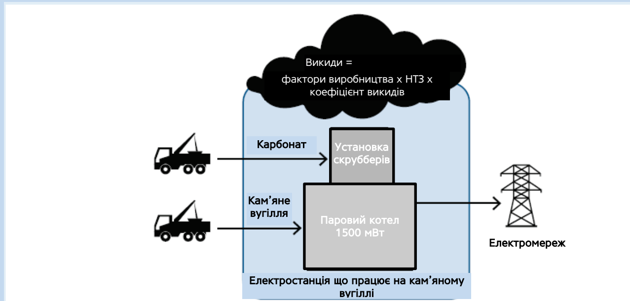
Рамка 7.1 ТЕХНІЧНА ЗАПИСКА: Спрощений приклад моніторингу (розрахунку) річних викидів на електростанції, що працює на кам'яному вугіллі
